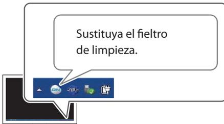
El fieltro de limpieza es un componente que se utiliza para limpiar los cabezales de impresión. Cuando el mensaje de la figura aparece en el icono de Utilidad de la bandeja de tareas del ordenador, debe sustituir la espátula por una de nueva.
