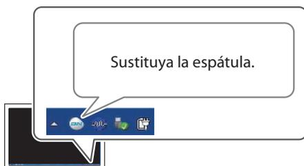
La espátula es un componente que se utiliza para limpiar los cabezales de impresión. Cuando el mensaje de la figura aparece en el icono de Utilidad de la bandeja de tareas del ordenador, debe sustituir la espátula por una de nueva.
