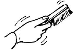
Una vez finalizada la operación de corte, desmonte la herramienta, retire el material y limpie las virutas.
