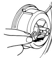
**3** Encaje el orificio del lado izquierdo del rollo de material completamente en el borde izquierdo del material.
