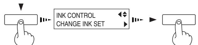
**4** Utilice las teclas [▲] y [▼] para seleccionar el nuevo tipo de tinta que se va a utilizar y a continuación pulse la tecla [ENTER].
