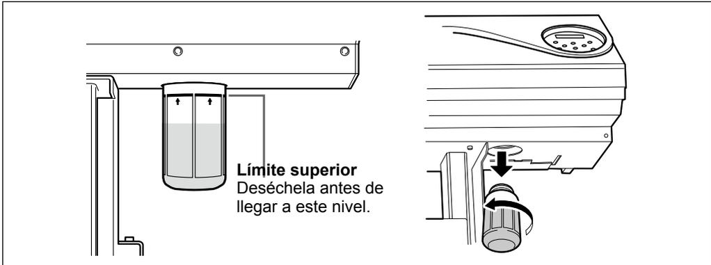
**⚠ PRECAUCIÓN** Antes de retirar la botella de drenaje, espere a que la pantalla muestre "EMPTY DRAIN BOTTLE".
