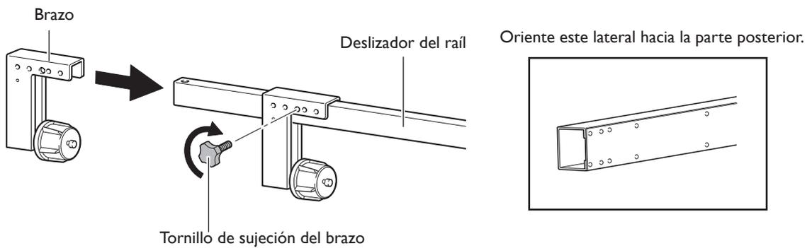
2 Instale el deslizador del raíl a las patas del soporte.
