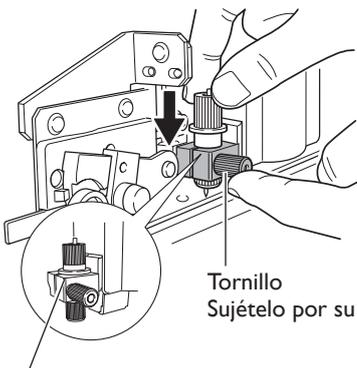
Sujete el tornillo por su parte inferior e instale el soporte para cuchillas.
