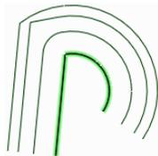
Hervorgehobene Versatzlinien unter Verwendung jeweils einer Option. Von oben nach unten: **Versatzlinie mit natürlichem Verlauf**, **Versatzlinie mit einer Kante** und **Versatzlinie mit einem Kreisbogen**.
