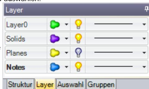
Layer sind besonders hilfreich, wenn Beschriftungsebenen ausgeblendet werden sollen. Erstellte Objekte werden automatisch auf dem aktiven Layer platziert.
