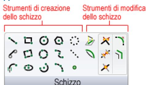
Il gruppo della barra multifunzione Schizzo contiene i seguenti strumenti di creazione dello schizzo:
