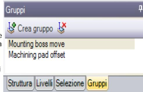
Viene creato un gruppo di raccordi anche ogni volta che si completa un raccordo. È possibile ricollegare un gruppo di raccordi purché nel disegno esista ancora la stessa porzione degli spigoli originali (o delle facce contigue agli spigoli).
